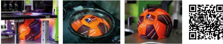
Le logo est imprimé directement sur la surface du ballon à l'aide d'une imprimante à jet d'encre UV.
